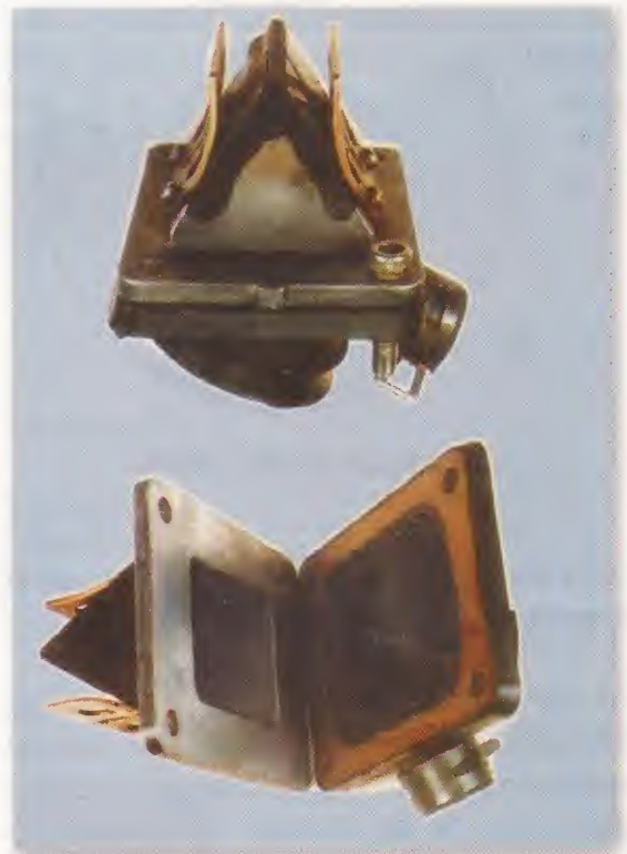
Vistas exterior e interior del torque
